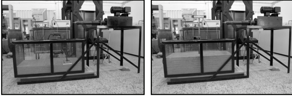
Fotoğraf 1 - Model kum zeminin deney kasasına yerleştirilmesi
