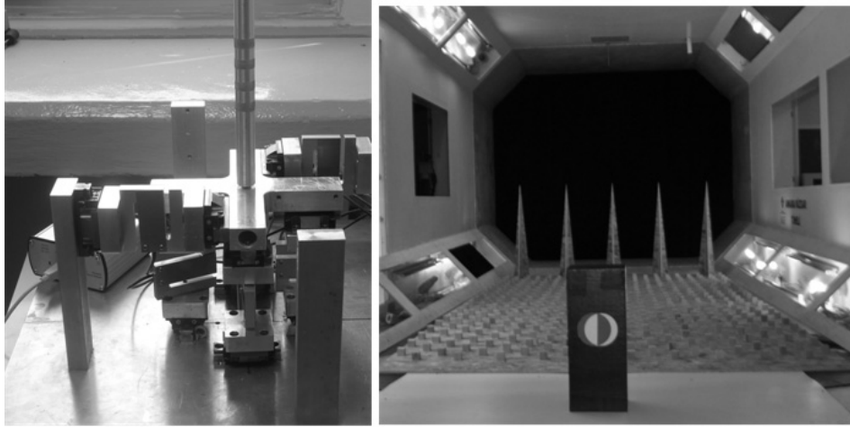
Şekil 10: Balans Sistemi ve Model Bina'nın Tünel İçi Yerleşimi
