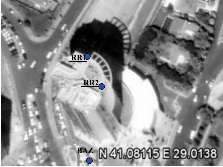
Şekil 14. GPS alıcılarının bina üzerindeki konumlarının uydu görüntüsü
