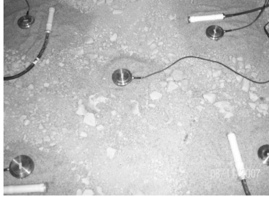
Şekil 8. Deney sırasında ölçüm cihazlarının taban zemini-alttemel tabakası arasına yerleştirilmesi
