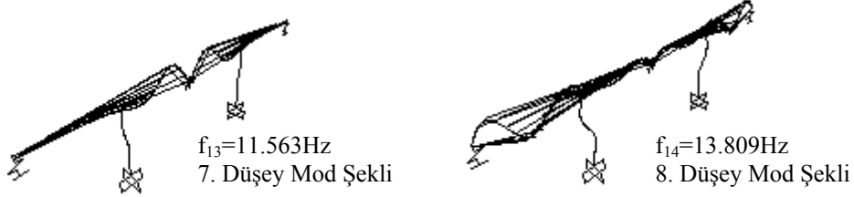
Şekil 4. Kömürhan köprüsünün analitik frekans değerleri ve mod şekilleri
