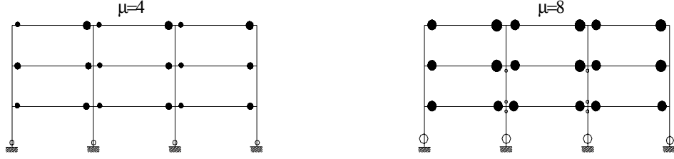
Şekil 6. 3 Katlı Çerçevede İzmit N-S Depremi Plastik Mafsal Dönme Değerleri
