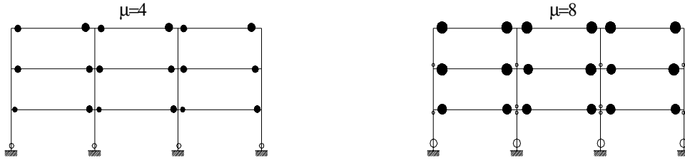
Şekil 7. 3 Katlı Çerçevede Miyagi N-S Depremi Plastik Mafsal Dönme Değerleri
