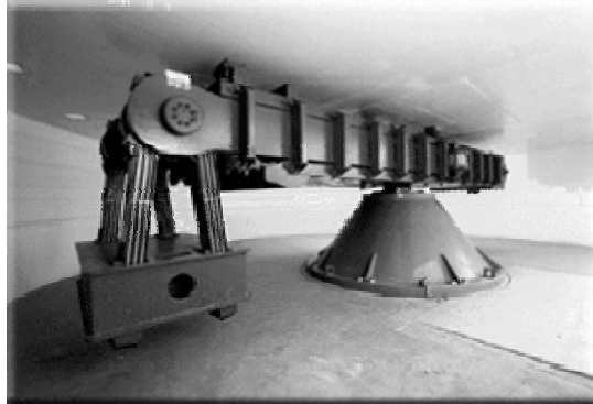
Şekil 4. Boulder'daki Colorado Üniversitesi'nde bulunan 400 g-ton'luk geoteknik santrifuj
