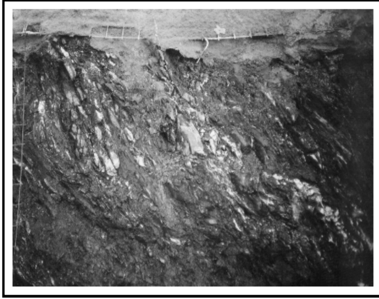
Şekil 5. Grafit şist (not: kaya kütlesi düzensiz ve gelişigüzel eklemlı, aşırı yapraklanmış ve ayrışmış olup, kil gibi davranım göstermektedir)
