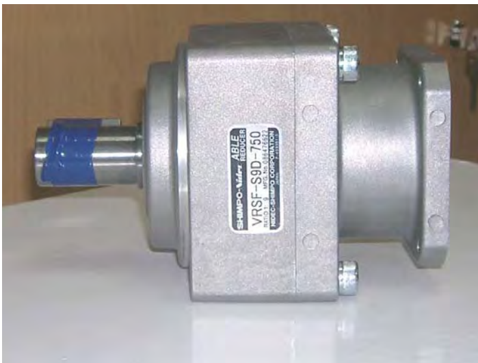
Şekil 4. Servo motorların gücünü artırmak için kullanılan redüktör
