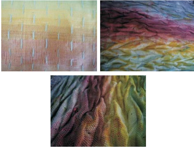
Şekil 8. Tasarım 4: Bezayağı örgüde çözgü takviyeli, Atkı sıklığı: 9 tel/cm, Çözgü sıklığı :10 tel/cm, Çözgü takviye sıklığı: 3 cm de 1 tel, Çözgü: pamuk, Atkı : polyester/ viskon, 40/2, 36/2, 80 tex polyester (Havva Halaçeli, 2011)
