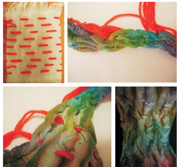
Şekil 2. Deneme 1: Bezayağı örgüde, atkı takviyeli- Atkı takviye sıklığı: 1,5 cm de 1 sıra (Havva Halaçeli, 2010)
