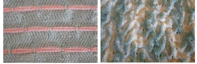
Şekil 10. Tasarım 6: D 1/3 z zikzak dimi örgüde atkı takviyeli, Çözgü sıklığı :16 tel/cm, Atkı sıklığı:8 tel/cm, Atkı takviye sıklığı: 2 tel/3 cm, Çözgü: pamuk, Atkı: parlak polyester iplik (Havva Halaçeli, 2011)
