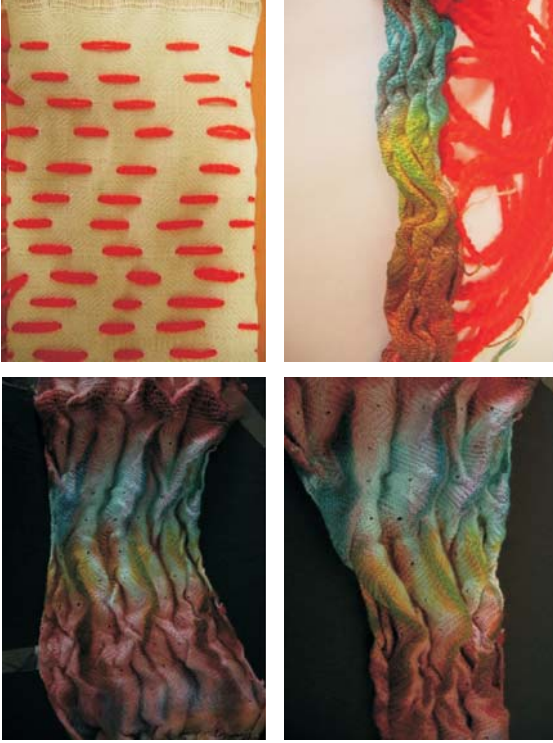
Şekil 3. Deneme 2: D 2/2 örgüde, atkı takviyeli - Atkı takviye sıklığı: 1,5 cm de 1 sıra (Havva Halaçeli, 2010)
