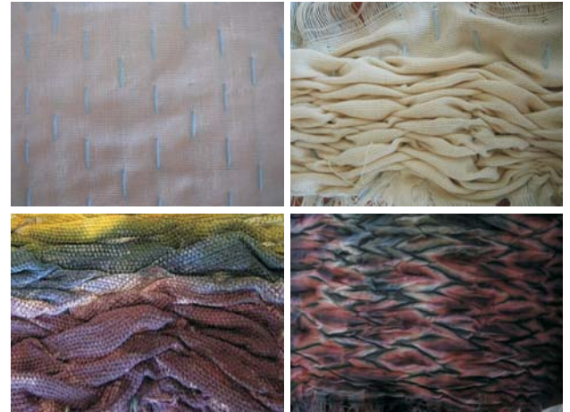
Şekil 6. Tasarım 2: Bezayağı örgüde çözgü takviyeli, Atkı sıklığı: 8 tel/cm, Çözgü sıklığı :10 tel/cm ,Çözgü takviye sıklığı: 3 cm de 1 tel, Çözgü: pamuk, Atkı: pamuk (Havva Halaçeli, 2011)
