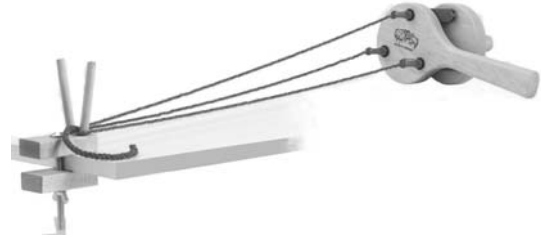
Şekil 2. Geleneksel urgan yolu metodu ile halat yapımı [2]
