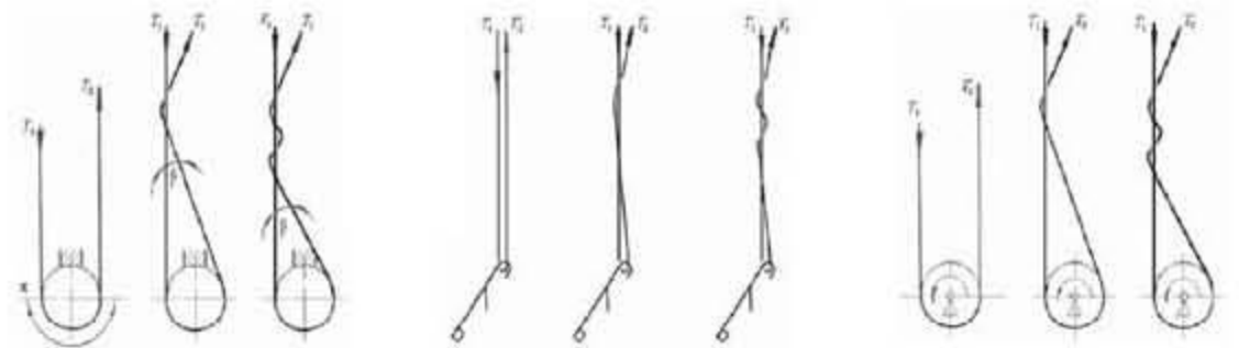
Şekil 8. İplik sürtünmesi ölçüm düzenekleri [22 ] a. İpliğin hareketsiz silindirden geçtiği düzenek b. İpliğin örme iğnesinden geçtiği düzenek c. İpliğin döner silindirden geçtiği düzenek
