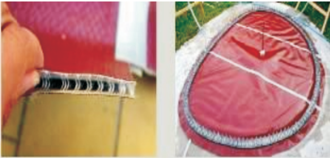
Resim 25: Çift katlı duvar kaplama kumaşı ve uygulaması [3]
