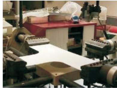
Resim 27: İki eksenli çekme testi [6]
