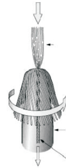
Şekil 2. Murata Vortex sisteminde iplik oluşumu (Gray 1999)
