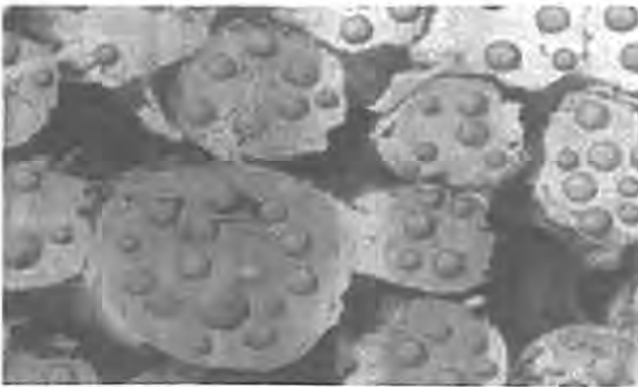
Şekil 23. Faz değiştiren materyal içeren mikrokapsüllerin lif içerisinde tekstil materyaline uygulanması [www.outlast.com]
