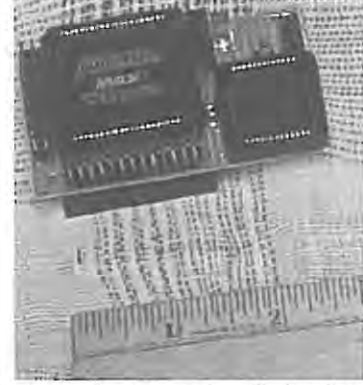
Şekil 3. Bir kumaş yapısı üzerine monte edilmiş mikro-elektronik yapılar
