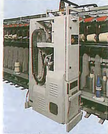
Resim 76. No.377 Makinası için otomatik iplik besleme ve takım çıkarma robotu.
