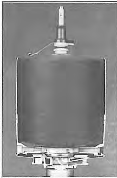
Resim 72. VTS bire-iki-büküm-bobin makinasının iğ sistemi
