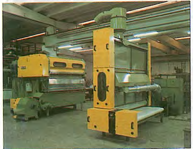
Resim 31. Bematic besleme sistemi
