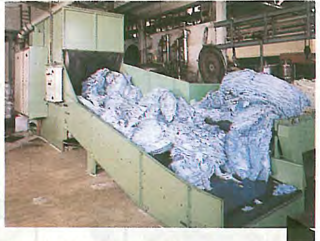
Resim 24. Abri-Pac 1600 açma makinası çalışma anında
