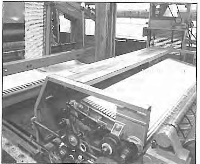
Resim 35. Galaxy 2000 ştrayhgarn tarağı geniş band ara besleme
