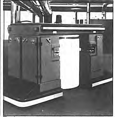
Resim 4. CANNY ONE kova-değiştirici robot
