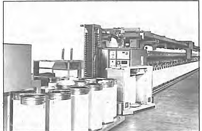
Resim 18. Autocoro otomatik kova değiştirme ve depolama birimi
