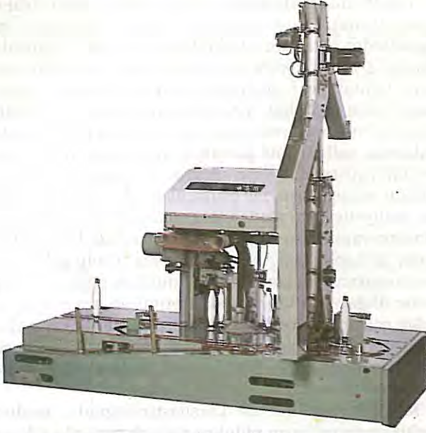
Resim 84. CBF kontinü masura besleme sistemi
