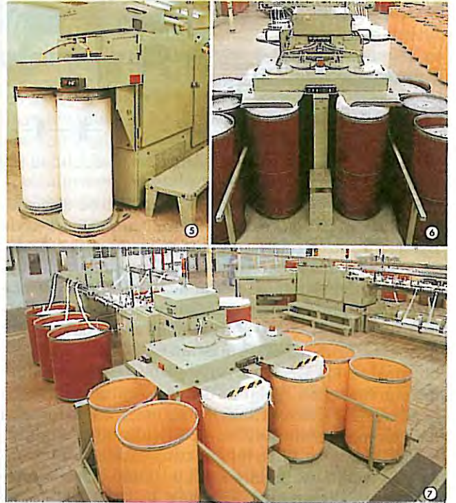
Resim 39. GN6 intersekting çekmesi makinası band çıkışı
