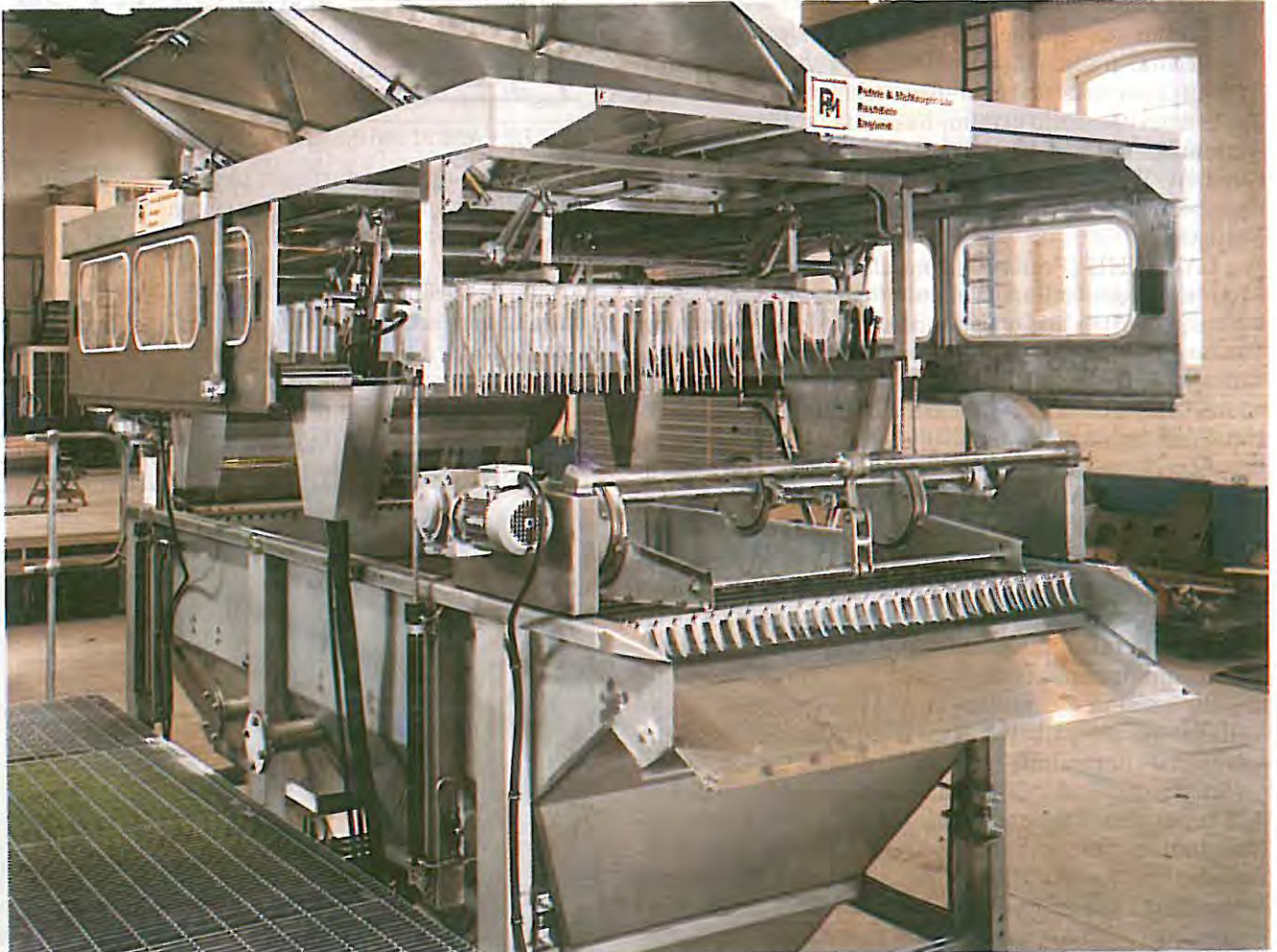
Resim 21. PETRIE & McNAUGHT mini-bowl (küçük-tekneli) makinasında urmuk sistemi
