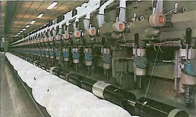
Resim 60. Houget Duesberg Bos. açık uç iplik eğirme makinası
