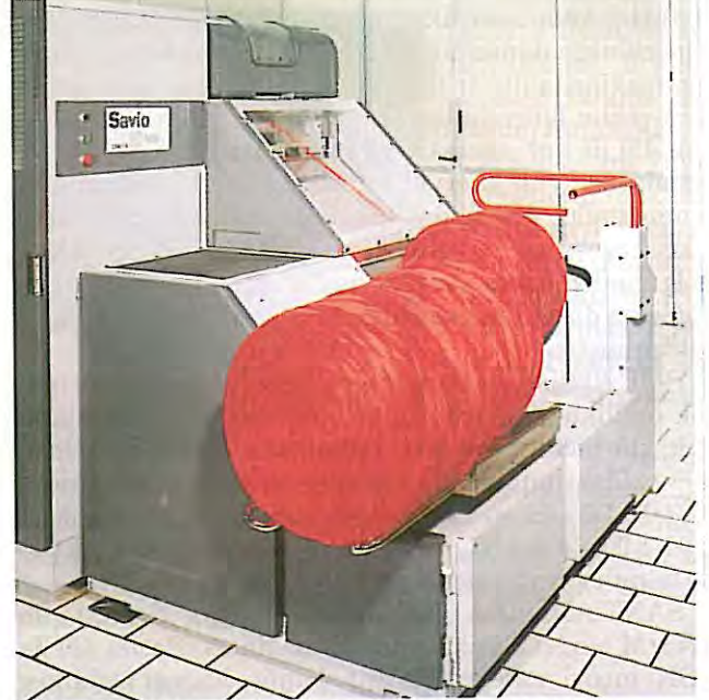
Resim 44. SC400 çekme makinasının otomatik bobin çıkışı
