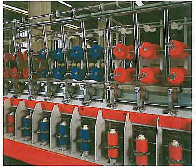
Şekil 68. Hamel 1000 bilezikli büküm makinası
