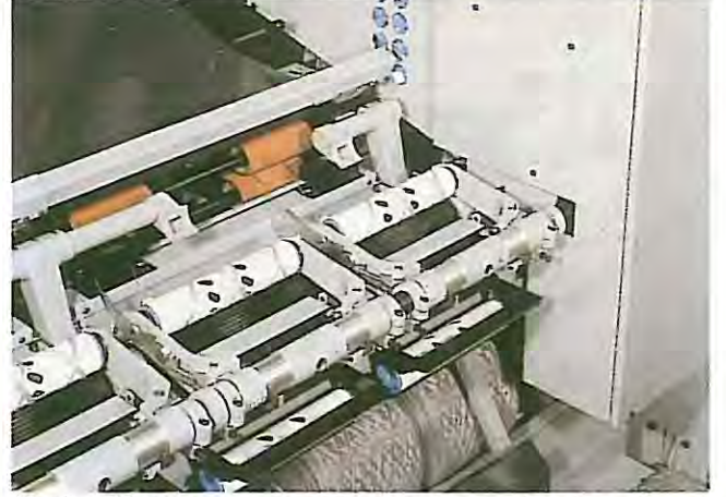
Resim 52. FRC300 yatay fitil finisörü otomatik takım çıkarma düzeni
