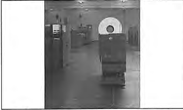
Resim 6. VOUK vatka taşıma robotu
