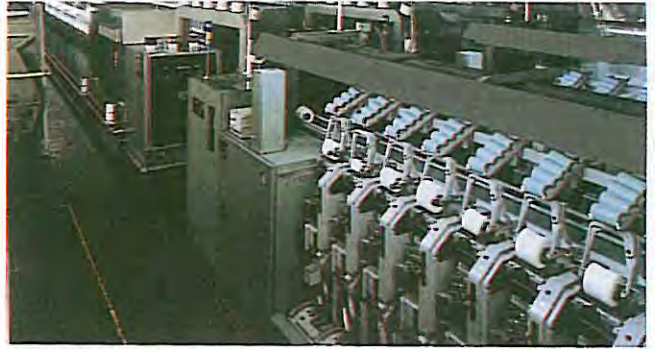
Resim 77. No.377 bire-iki büküm-bobin makinasını doğrudan bobin makinasından besleyen "link" sistemi
