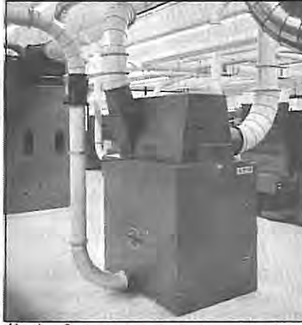
Resim 3. B 1/1 tek silindirli temizleyicinin dış görünüşü
