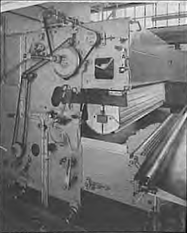
Resim 28. Microweigh 2000 besleme sistemi
