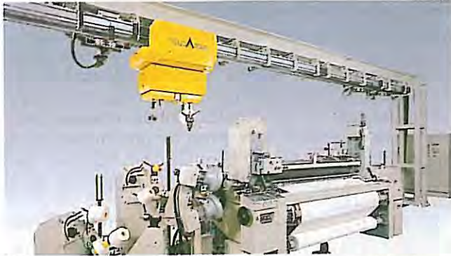
Şekil 4. Tsudakoma hava jetli tezgahlarda otomatik atkı onarım (AFR) ve otomatik atkı uzaklaştırma (APR) sistemleri
