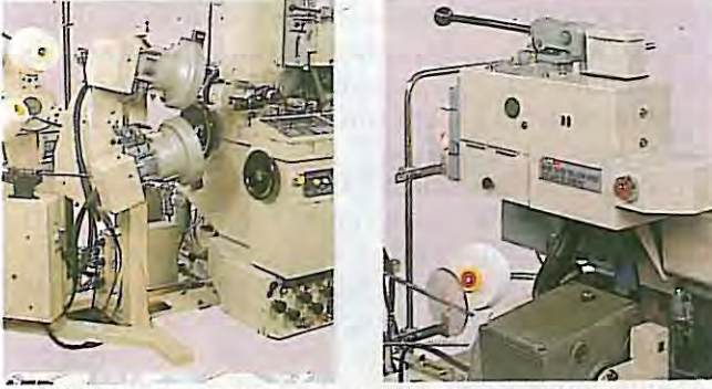
Şekil 4. Tsudakoma hava jetli tezgahlarda otomatik atkı onarım (AFR) ve otomatik atkı uzaklaştırma (APR) sistemleri
