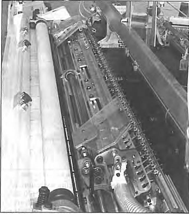
Şekil 39. Vamatex Typhoon çıplak ağızlıkta düzelerin konumu ZTM Master serisini de geliştirmiş filament ve kesikli lif iplikler için A ve B versiyonları üretilmektedir. 190cm nominal çalışma genişliğindeki Master A, 1100d/dak hız ile çalışırken aynı endeki B tipi kesikli lif dokuyan tezgah 700d/dak'ya ulaşabilmektedir.
