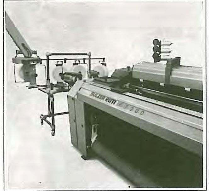
Şekil 6. Sulzer-Ruti atkı bobini taşıma ve yerleştirme robotu
