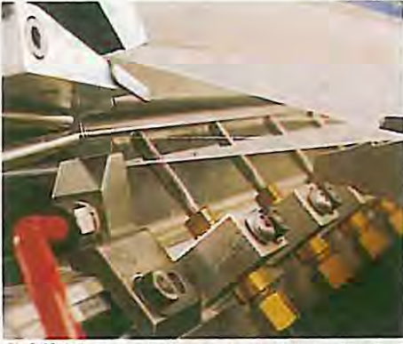
Şekil 36. Hava jetli tezgah ağızlığı ve düzelerin konumu (S-Ruti)
