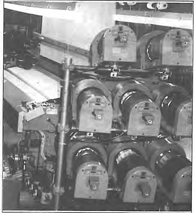
Şekil 40. Günne Air-Jet 2000 jakarlı tezgahı 8 renkli atkı seçimi gidilmemiştir. Günne firmasının geliştirdiği önemli diğer bir yenilik atkı sıklığında değişim sağlayan, özellikle havlu dokumada, bir aygıt olmuştur. Servo motor kontrollü kumaş çekme ve elektronik çözgü salma sistemi eşzamanlanarak önceden belirlenen atkı sıklıkları elde edilir.
