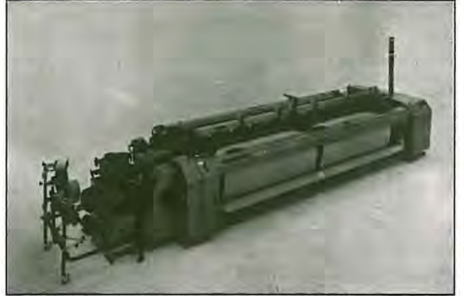
Şekil 16. Sulzer-Ruti P7200 mekikçikli dokuma makinası (360cm nom. genişlikte çift en, 4-renk atkı ve elektronik armürlü)
