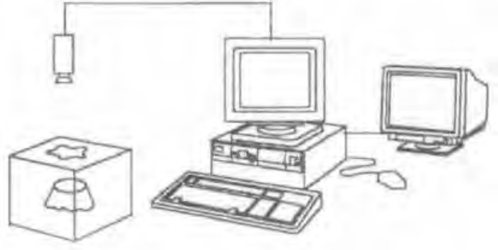
Şekil 1. Dökümlülük ölçümünde kullanılan görüntü analizi sistemini diyagramı [6]
