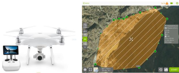
Şekil 7. Görüntü almak için kullanılan İHA Phantom 4 Pro V2.0 ve Uçuş Planı
