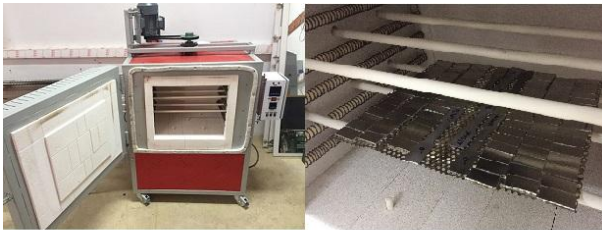
Şekil 2. Tavlama ortamı (a) PID Üniteli Fırın; (b) Deney ve Test Numuneleri
