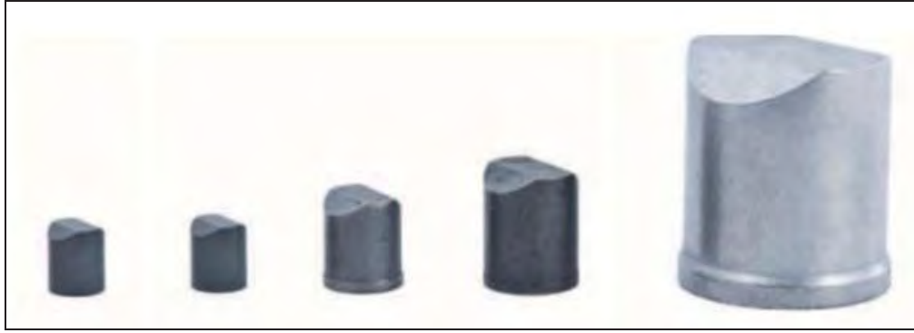
Şekil 11. US-MIL-P-46593'te tanımlanan parçalanma taklit edici parçacıklar ( Fragment Simulating Projectiles ) [45].
