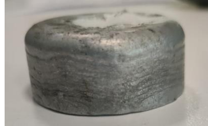
Şekil 3 : Dökümü alınan 403*202 mm boyutundaki silindirik numune.
