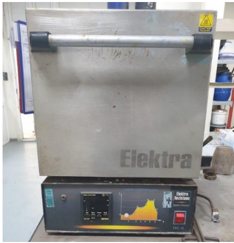
Şekil 1. Ergitme işlemi 1200°c kapasiteli Elektra Rezistans Markalı kül fırınında gerçekleştirilmiştir
