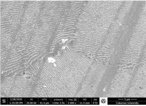
Şekil 9. %0,1 Sr içeren suda soğutulmuş galfan mikro yapısı
