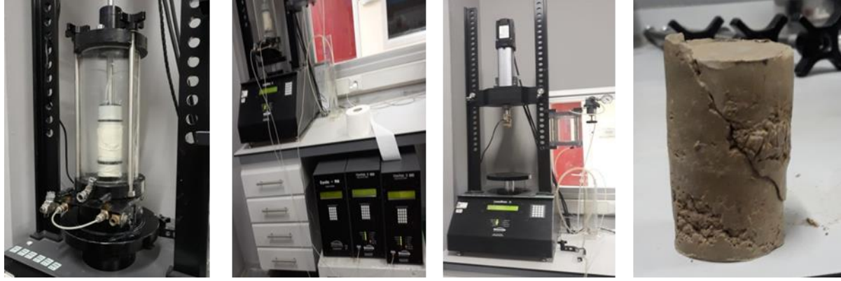
Şekil 2. Üç eksenli basınç deney düzeneği
