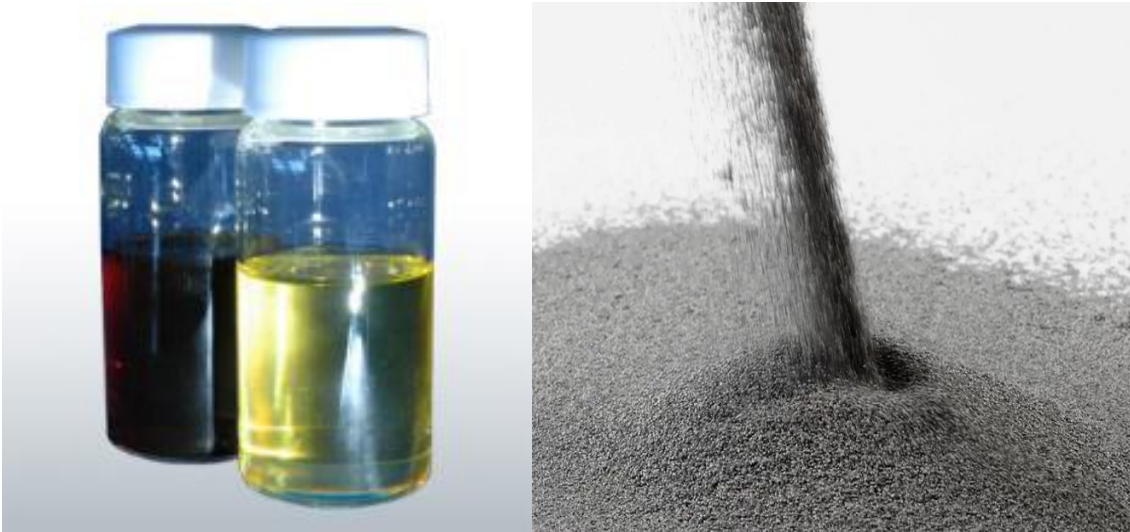
Şekil 6. Bağlayıcı Kimyasal Örneği (solda), Metal Toz örneği (sağda) [16,17].
