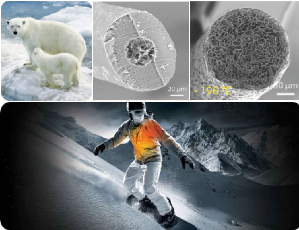
Resim 10: Kutup ayısı (üst sol), kutup ayısının oyuk ve gözenekli kıl yapısı (üst orta), Cui vd. (2018) tarafından geliştirilen lif (üst sağ). Thermolite lifi ve bu liften yapılmış kıyafet (alt)
