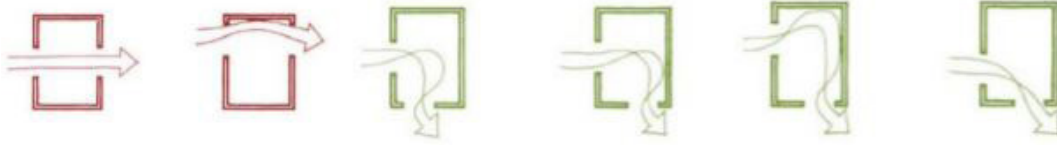
Şekil 2. Yapı tasarımının hava hareketlerine etkisi (Watson ve Labs, 1992).
