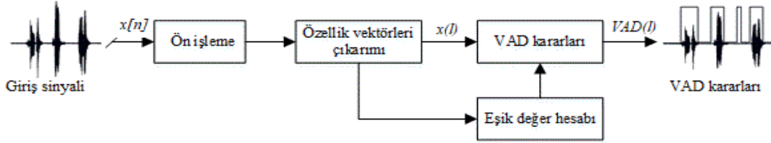
Şekil 1. Genel bir VAD algoritmasının blok şeması (Block diagram of a general VAD algorithm)
