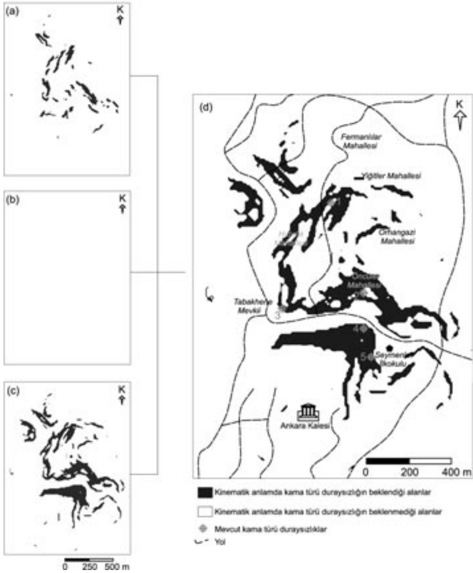
Şekil 12. İnceleme alanı için kama türü duraysızlık potansiyelinin belirlenmesi: (a) I_{1,2} , (b) I_{1,3} , (c) I_{2,3} ve (d) tüm inceleme alanı için.
