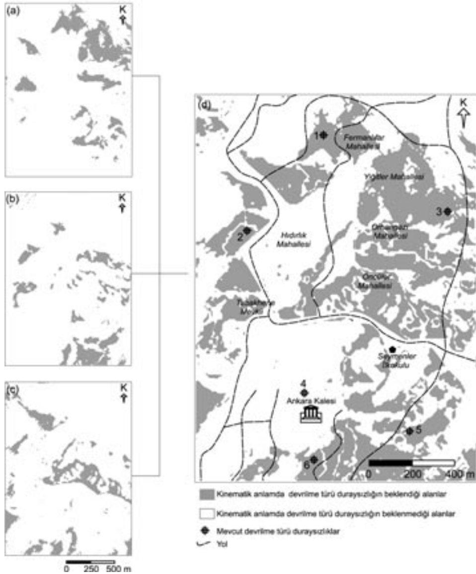
Şekil 13. İnceleme alanı için devrilme türü duraysızlık potansiyelinin belirlenmesi: (a) set 1, (b) set 2, (c) set 3 ve (d) tüm inceleme alanı için.
