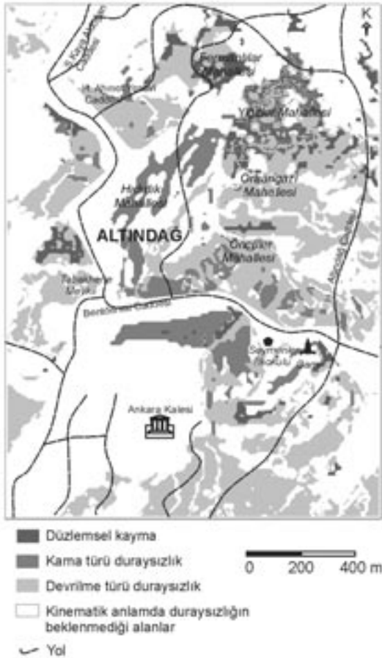
Şekil 14. İnceleme alanı için süreksizlik denetimli potansiyel şev duraysızlığı haritası.
