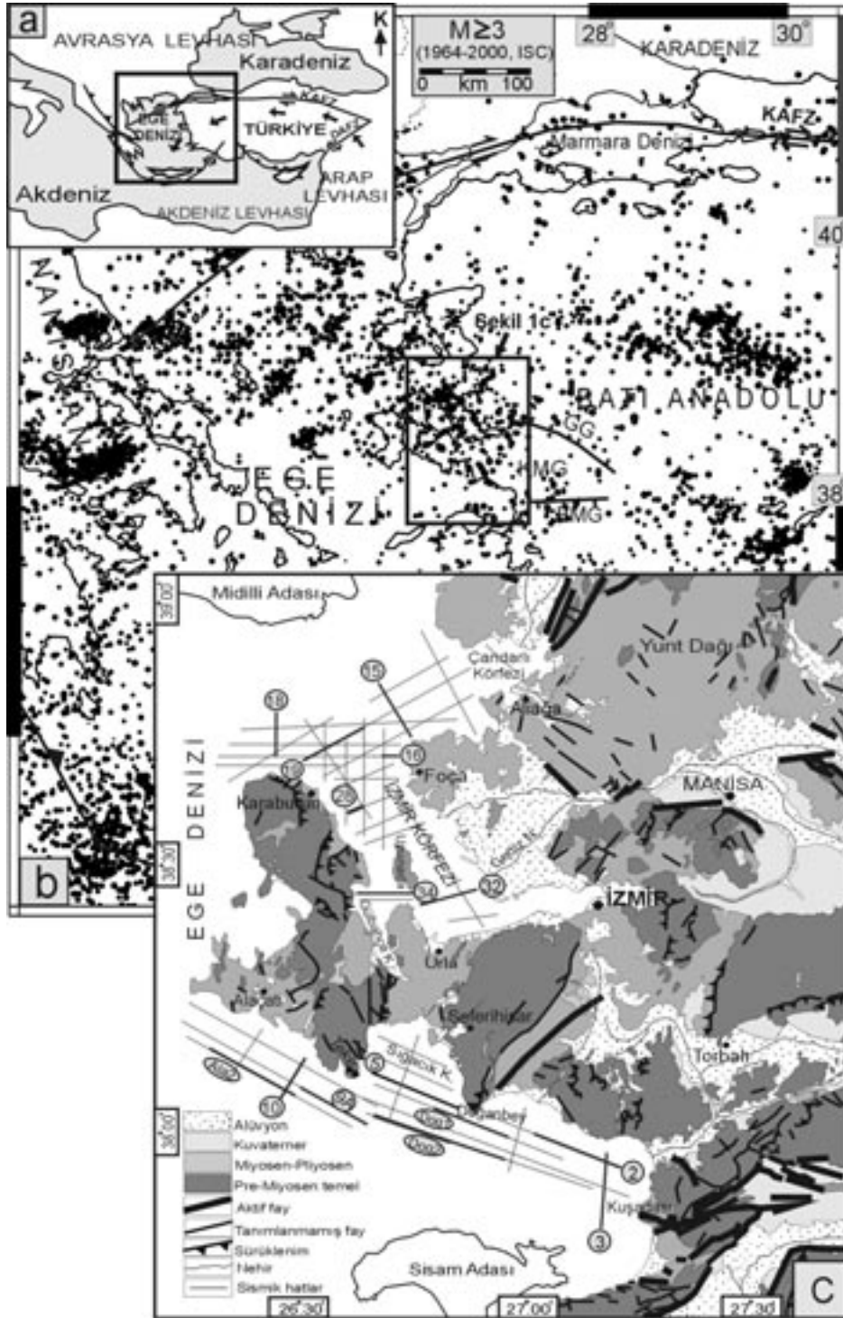
Şekil 1. (a) Ege bölgesi ve yakın bölgelerin genel tektonik haritası, (b) Ege bölgesinin ISC kayıtlarından alınan (ISC,2000) 1964-2000 yılları arasındaki büyüklüğü M 3 depremler için merkezüstü dağılım haritası, (c) İzmir Körfezi ve dolaylarının jeolojisi (MTA, 2002a ve 2002b'den değiştirilerek) ve sismik hatların lokasyon haritası (hatların koyu renkli kısımları metin içerisinde yer alan sismik kesitlerin yerleridir).
