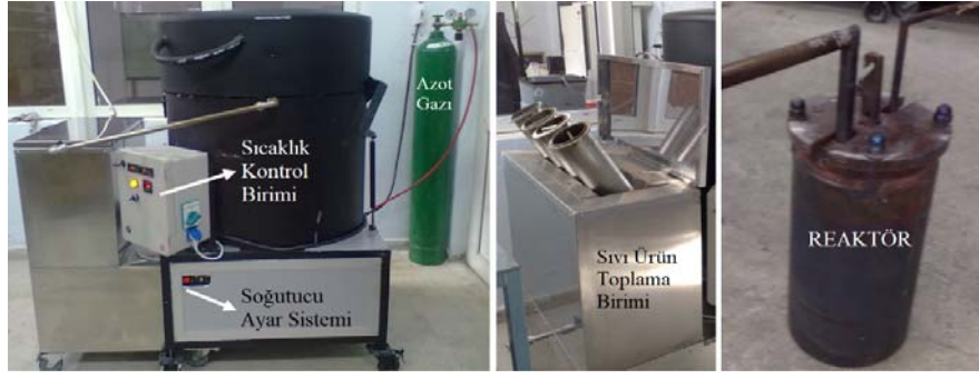
Şekil 3. Laboratuvar ölçekli piroliz deney sistemi (Laboratory-scale pyrolysis test system)
