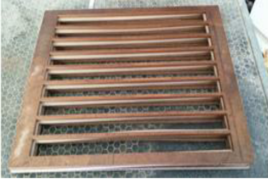
Şekil 6. Tek bindirmeli kayma numunesi üretimi için tasarlanan ve MDF den üretilen kalıp
