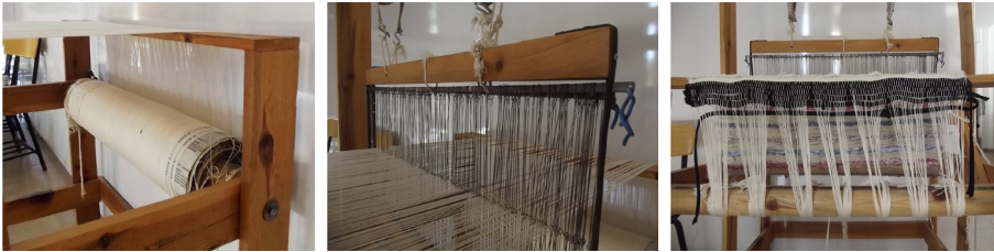
Fotoğraf 13-14-15. Levent Üzerine Sarılı Çözgü İpliği-Gücü Telleri-Dişli
