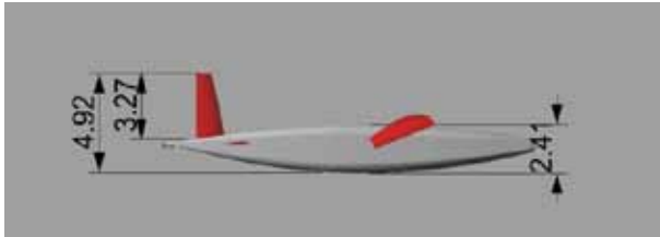
Resim: Çaka Bey Su Üstü Seyir Hali Profil Görünüşü (1=1 metre)
