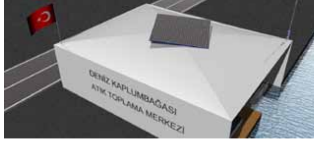
Resim 4. Tesisin çatısında güneşin konumuna göre açısını değiştirebilen güneş paneli
