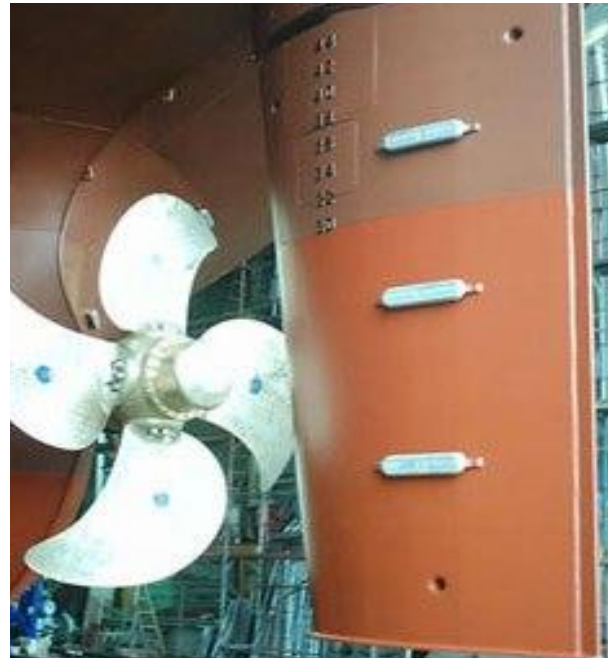
Şekil 4. Sabit Hatveli Pervane ve Vec-Twin Özel Dümen (2x1)
