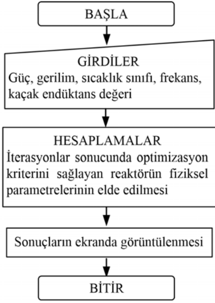
Şekil 3. Tasarım yazılımı basit akış şeması (Simple flow chart of the calculation method)
