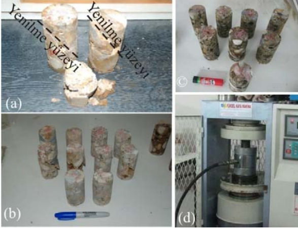
Şekil 6. Karot örneklerin üç eksenli sıkışma deneyi sonrası görünümleri (a), örneklerin kuru haldeki görünümleri (b), örneklerin suya doygun haldeki görünümleri (c), üç eksenli sıkışma dayanımı deneyinden bir görünüm (d).
