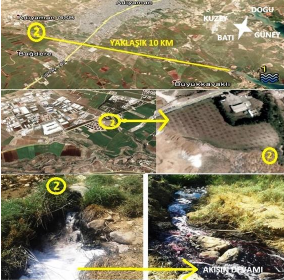
Şekil 1. ADOSB endüstriyel atık suyu 2014 yılı itibariyle deşarj noktaları (1) Eğri Çayı yatağının Atatürk Baraj Gölü'ne bağlandığı nokta; (2) ADOSB endüstriyel atıksuyunun Eğri Çayı'na deşarj edildiği nokta.
