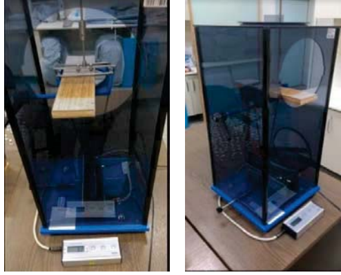
Şekil 4. Pandüllü sertlik cihazı ve sertlik deneyi
