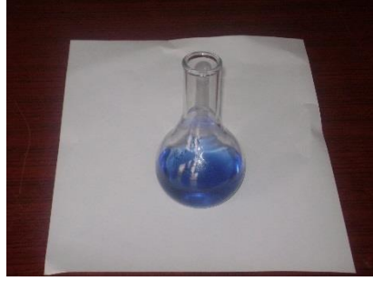
Şekil 2. Kasarlı normal pamuğun reaktif boyalarla boyama sonrası atık banyo görünümü.
