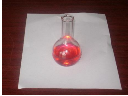
Şekil 4. Kasarlı normal pamuğun direkt boyalarla boyama sonrası atık banyo görünümü.
