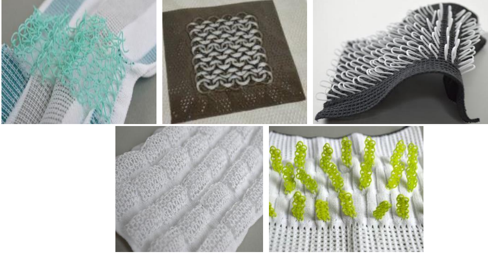
Şekil 5. 3B yazıcılarla üretilmiş ilmeli örme yüzey denemeleri (Millsaps, 2014)
