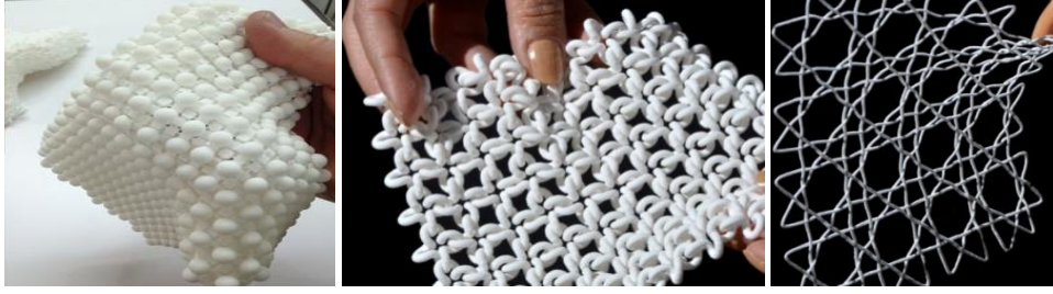
Şekil 7. 3B yazıcılarla tekstil yüzey denemeleri (Tekstil yüzeyleri, 2014)
