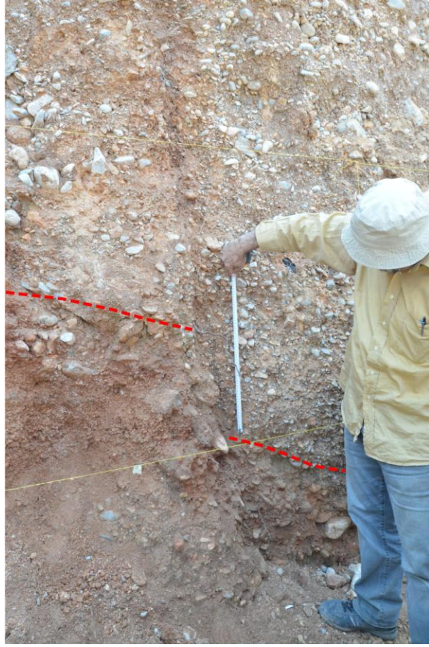
Şekil 15. Logun 2. ve 3. metreleri arasında yer alan fayın ve üzerindeki düşey yerdeğiřtirmenin görünümü (Bakış yönü D'ya).
