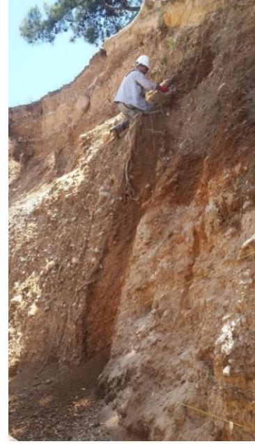
Şekil 16. Logun 6. metresinde görülen ana fay kolu ve güneyindeki diđer fay ve açılma yapıları.
