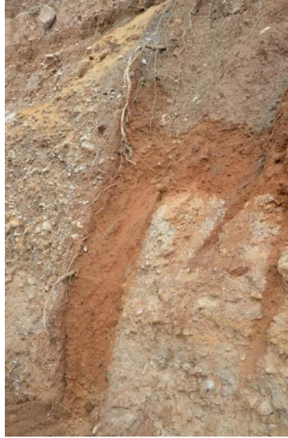
Şekil 16. Logun 6. metresinde görülen ana fay kolu ve güneyindeki diđer fay ve açılma yapıları.
