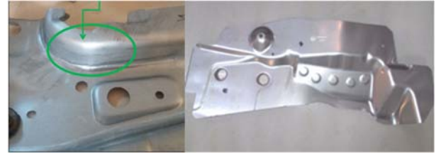
Şekil 9. Çatlak olmayan parça örnekleri (Non cracked part samples)
