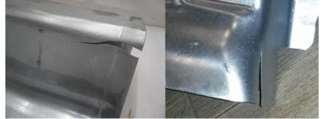
Şekil 8. Çatlak parça örnekleri (Cracked part samples)
