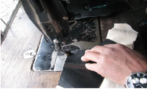
Fotoğraf No 9: Yan parçaların önden birleşimi ve birleşen parçaların üstüne deri ile makinede süs yapımı
