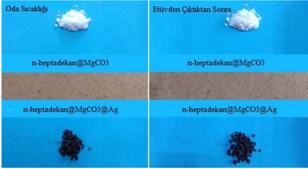
Şekil 10. Sentezlenen Mikrokapsüllerin Isıl Kararlılık Testi (Thermal Stability Test of Synthesized Microcapsules)
