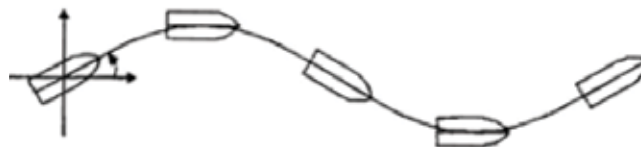
Şekil 16. Düzlemsel hareket mekanizmasının hareket modları (Can, 2014).
