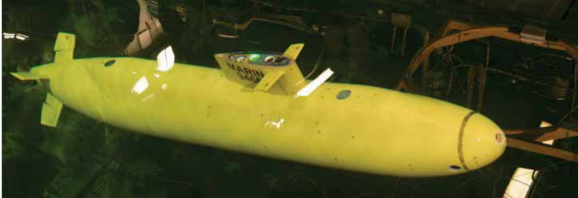
Şekil 12. Max "q" manevrası yapan serbest hareketli BB2 modeli (Overpelt et al., 2015).
