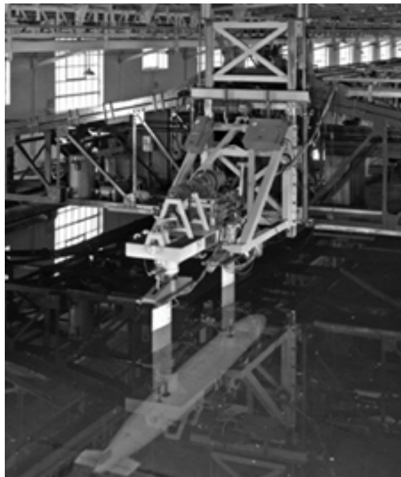
Şekil 17. Denizaltı modelinin düzlemsel hareket mekanizması kullanılarak test edilişi (Renilson, 2018).
