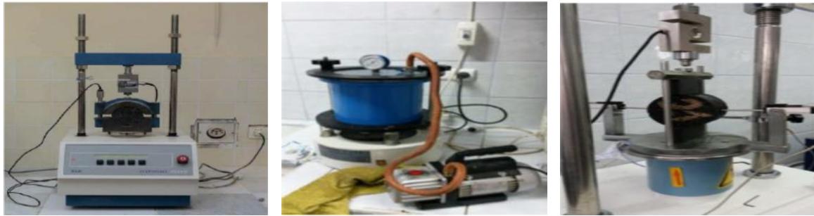
Şekil 3. Marshall stabilite deney cihazı (a), Numunelere vakum uygulanması (b), ITS deney cihazı (c)
