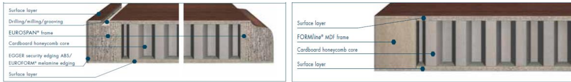
Şekil 14. Sandviç levhalarda kenar dolgu/besleme yöntemleri (URL2, 2014. İzin alınmıştır.)
