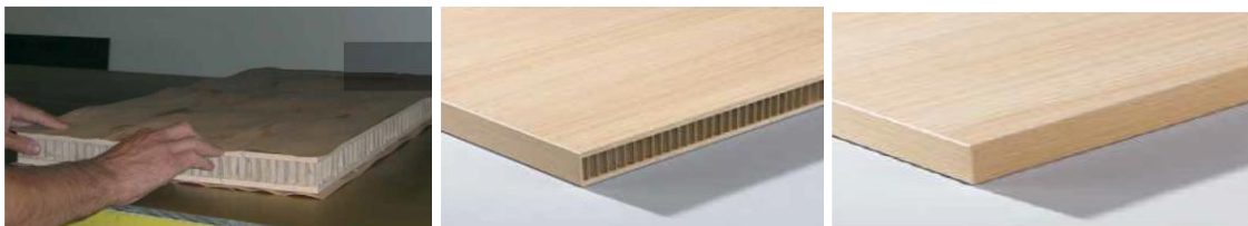
Şekil 17. Kağıt petekli levhaya kaplama preslenmesi ve kenar bant uygulaması (URL2, 2014. İzin alınmıştır.)
