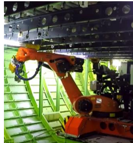
Şekil 5. Uçak gövde montajında robot uygulamaları (Robot applications in aircraft fuselage assembly) [39]
