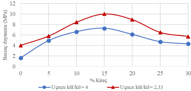
Şekil 2. Basınç dayanımının kireç miktarına bağlı olarak değişimi (28 gün yaşta).
