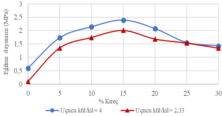
Şekil 3. Eğilme dayanımının kireç miktarına bağlı olarak değişimi (28 gün yaşta).
