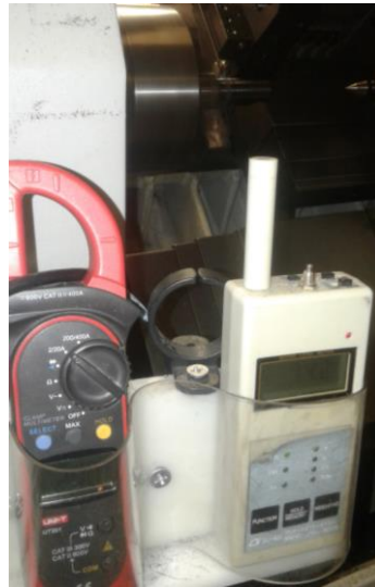
Şekil 1. Deney düzeninde akım değeri ve ses şiddeti değerlerinin ölçülmesi
